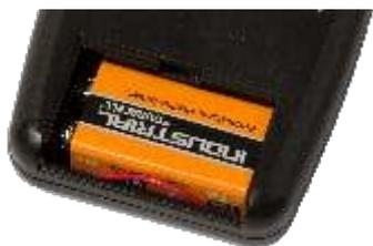
Coloque la batería en el compartimento de la batería asegurándose de que el conector de la batería está en el lado izquierdo (según se mire) y el cable de la batería pasa por la parte inferior del compartimento de la batería.
